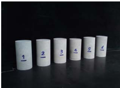
شکل ۴ نمونه‌های ماسه‌سنگ پس از مغزه‌گیری و برش
