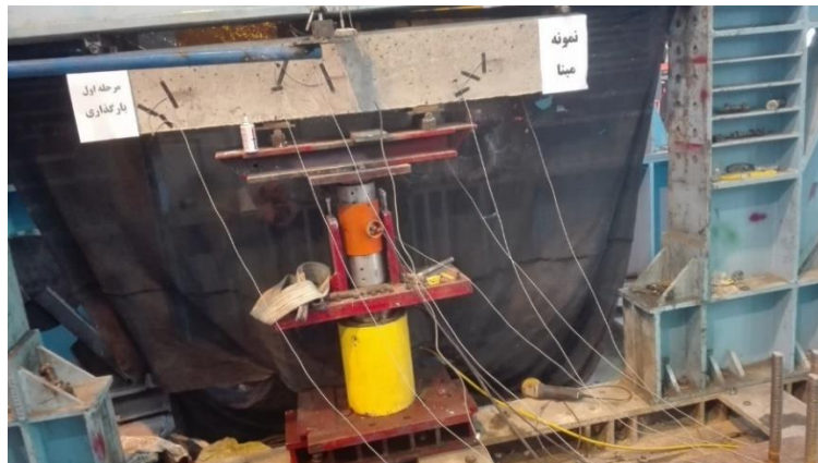
شکل ۴ انجام بارگذاری بر روی نمونه‌های ساخته شده با استفاده از دستگاه بارگذاری چهار نقطه‌ای
