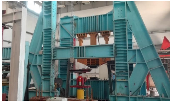
شکل ۳ آزمایش چهار نقطه‌ای
