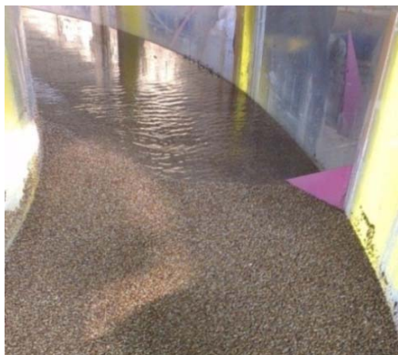
شکل ۲ نحوه‌ی قرارگیری صفحه‌ی مثلثی شکل در قوس ملایم ۹۰ درجه ( L_e=10\text{ cm} , \theta=72^\circ )
