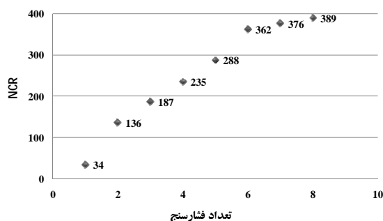
شکل ۳ تعداد موقعیت‌های صحیح شناسایی نشت (NCR) به صورت تابعی از تعداد فشارسنج
