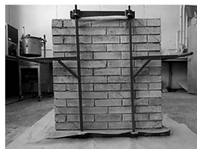
شکل ۵ سیستم حمل دیوار
