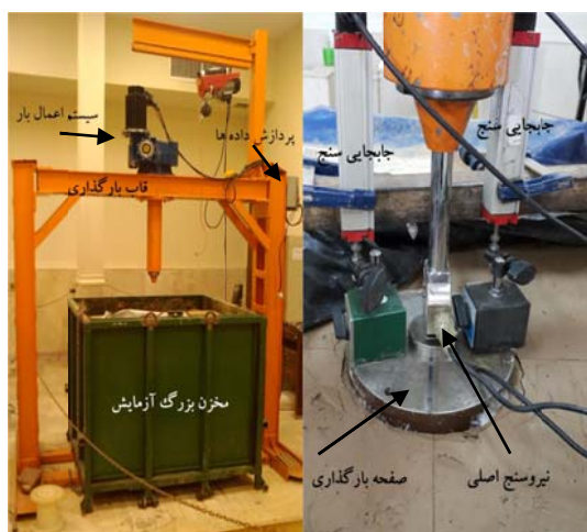
شکل ۲ مخزن و دستگاه بارگذاری و ثبت بار
