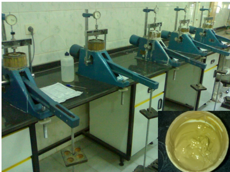
شکل ۱ دستگاه‌های تحکیم مورد استفاده و نمونه‌ی آزمایشی با رطوبت اولیه‌ی بیش از حد روانی
