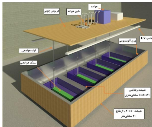
شکل ۱ تصویر شماتیک فتوراکتور استفاده شده در تحقیق
