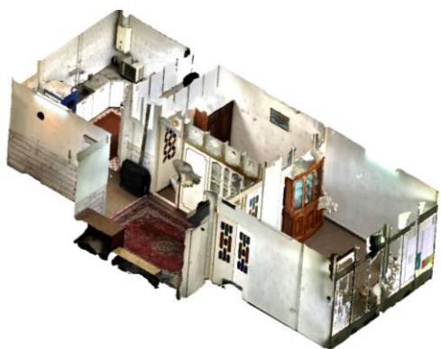
شکل ۱۰ تهیه مدل اطلاعات ساختمان معتبر و منطبق بر واقعیت با استفاده از نقشه دوبعدی و اطلاعات سه‌بعدی ابرنقاط
