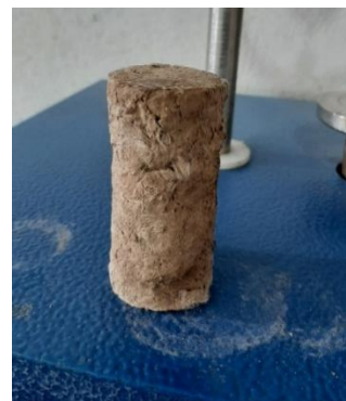
شکل ۱۲ نمونه بهسازی شده با PE و LS پس از چرخه دوازدهم گسیختگی
