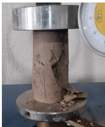
شکل ۱۱ گسیختگی نمونه بهسازی شده با LS پس از چرخه دوم
