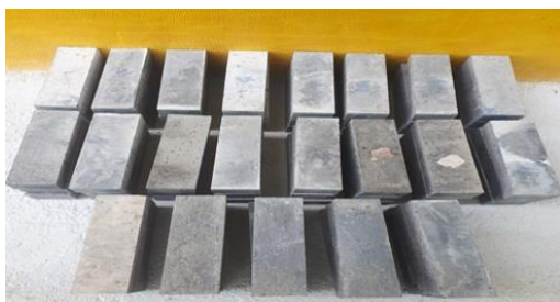
شکل ۴ نمونه‌های منشوری (تیر) ساخته شده برای آزمایش مقاومت خمشی
