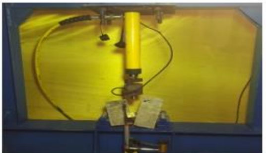
شکل ۶ نحوه آزمایش و شکست نمونه‌های تیر منشوری
