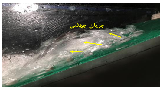
شکل ۸ جریان جهشی در موقعیت نصب L_b/L_f=0.2, 0.4 و تقعر در برابر جریان بلوک‌های مثلی
