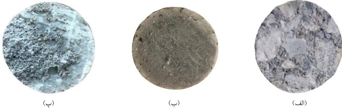
شکل ۱۱ انواع شکل گونه‌های شکست: (الف) بستر سیمانی (G)، (ب) سطح تماس (E) و (پ) ترکیبی (F)
