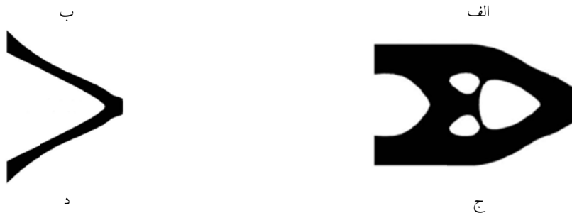
شکل ۱۸ برگرفته از [15] الف) تیر یک سر گیردار مستطیلی، ب) تغییرات تابع هدف و قید حجم، ج) تغییرات ساختاری در فضای فیزیکی و پارامتری مسئله، د) پروفیل بهینه
