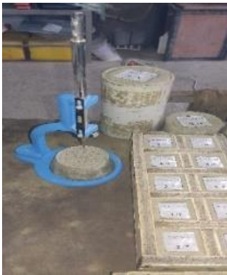
شکل ۶ گیرش نمونه آزمایشی تحت آزمایش ویکات
