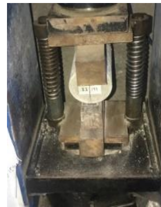
شکل ۵ نمونه استوانه‌ای تحت آزمایش کشش برزیلی
