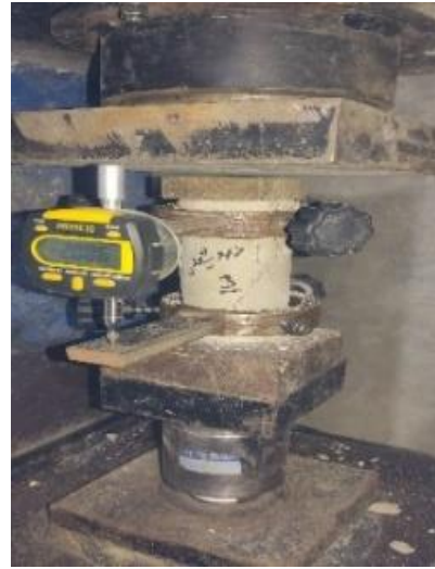
شکل ۷ نمونه استوانه‌ای تحت آزمایش مدول الاستیسیته
