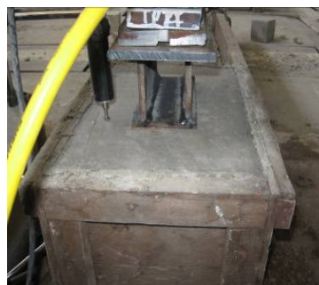
شکل ۵ تکیه‌گاه فلزی منتقل‌کننده‌ی بار
