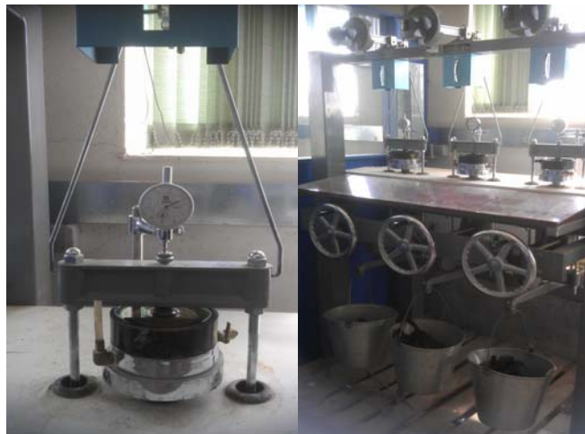
شکل ۴ دستگاه آزمایش تحکیم یک‌بعدی
