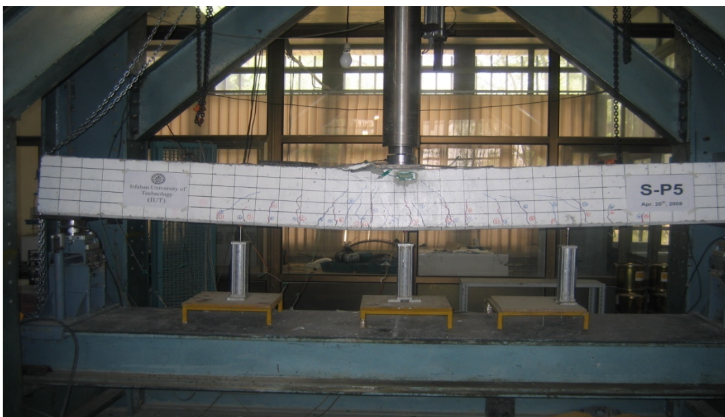
شکل ۴ تنظیمات آزمایشگاهی برای بارگذاری و ثبت اطلاعات نمونه‌ها
