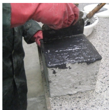
شکل ۲ اعمال چسب روی صفحه‌ی الیاف کربنی
