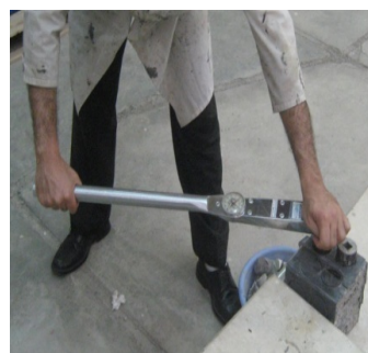
شکل ۷ اعمال گشتاور پیچشی به وسیله‌ی پیچش سنج دستی
