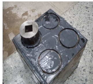
شکل ۶ چسباندن استوانه‌ی فولادی به سطح CFRP
