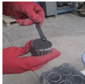
شکل ۵ اعمال چسب اپوکسی به استوانه‌ی فولادی
