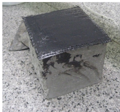
شکل ۱ قرار دادن صفحه‌ی الیاف کربنی روی چسب‌های اعمال شده
