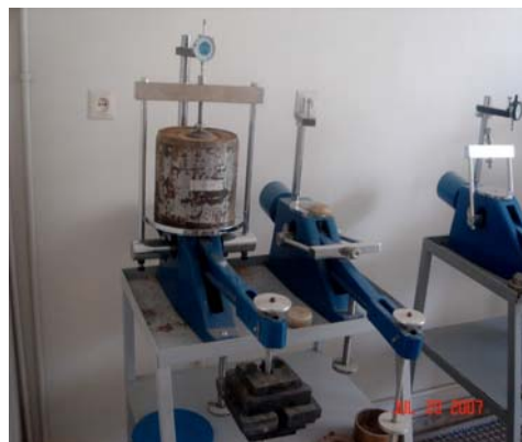
شکل ۳ دستگاه تحکیم با تغییراتی در ابعاد آن جهت آزمایش بارگذاری صفحه در آزمایشگاه
