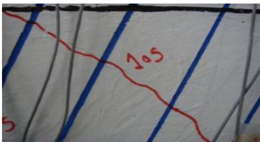
ب) اولین ترک برشی در بار 105 \text{ kN} در نمونه‌ی (BFI)
