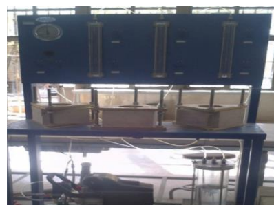
شکل ۶ دستگاه تست نفوذناپذیری آب طبق استاندارد EN 12390-8
