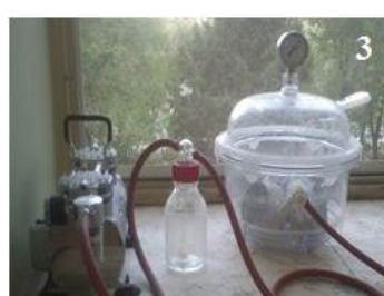
شکل ۴ مراحل انجام آزمایش نفوذ تسریع‌یافته یون کلرید: (۱) برش نمونه استوانه‌ای به ارتفاع ۵ سانتی‌متر، (۲) عایق کردن نمونه با رزین، (۳) قرارگیری نمونه‌ها در محفظه خلأ، (۴) ثبت بار الکتریکی عبوری از نمونه توسط دستگاه عبور جریان
