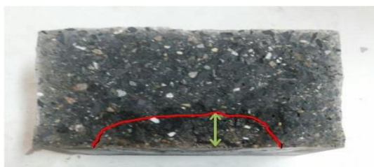
شکل ۷ نحوه اندازه‌گیری عمق نفوذ آب
