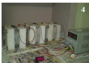
شکل ۴ مراحل انجام آزمایش نفوذ تسریع‌یافته یون کلرید: (۱) برش نمونه استوانه‌ای به ارتفاع ۵ سانتی‌متر، (۲) عایق کردن نمونه با رزین، (۳) قرارگیری نمونه‌ها در محفظه خلأ، (۴) ثبت بار الکتریکی عبوری از نمونه توسط دستگاه عبور جریان
