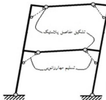
شکل ۲ مکانیزم تسلیم مورد انتظار در قاب خمشی با مهار زانویی [6]
