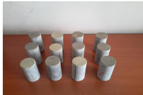
ه) نمونه‌های اخذ شده برای تعیین مقاومت فشاری گروت سیمانی شکل ۳ آماده‌سازی و اجرای میخ‌های قائم و افقی در سایت توسط دستگاه حفاری با مت‌سه‌پره‌ای و ضربه‌ای
