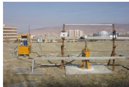
ب) سیستم جک و ملحقات آن نصب‌شده در سایت مورد مطالعه
