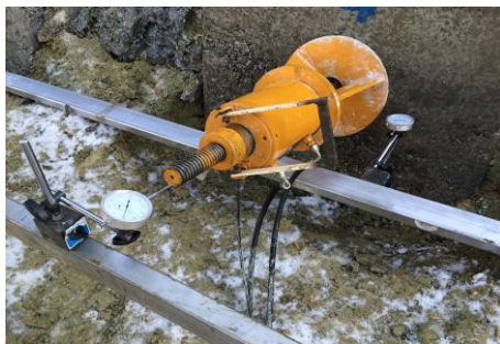
د) رابط اتصال جک به میخ و نصب گیج‌های اندازه‌گیری
