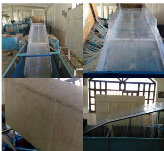
شکل ۱ تصاویری از مدل فیزیکی سرریز سد سورک و تابلوی پیزومترها
