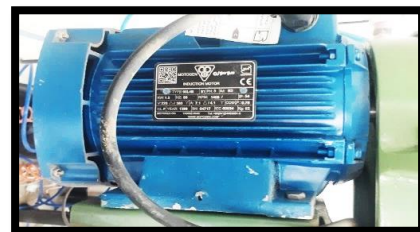
شکل ۹ موتور دستگاه آزمایشگاهی سنجش سایش خاک
