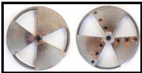
شکل ۱۱ کله حفار دستگاه آزمایشگاهی سنجش سایش خاک سمت راست: نمای جلو همراه با سوراخ‌های محل نصب پین، سمت چپ: نمای عقب
