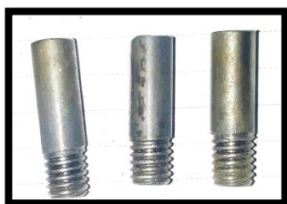
شکل ۱۴ ابزارهای برشی مورد استفاده در دستگاه آزمایشگاهی سنجش سایش خاک
