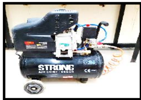
شکل ۸ کمپرسور هوای دستگاه جدید آزمایشگاهی سنجش سایش خاک
