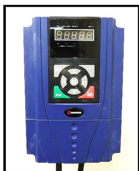
شکل ۷ دستگاه تنظیم سرعت چرخش کله‌حفار (اینورتور)
