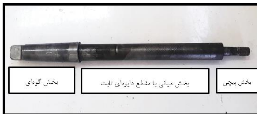
شکل ۱۰ شفت دستگاه آزمایشگاهی سنجش سایش خاک
