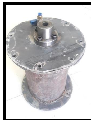
شکل ۱۲ محفظه حفاری دستگاه آزمایشگاهی سنجش سایش خاک
