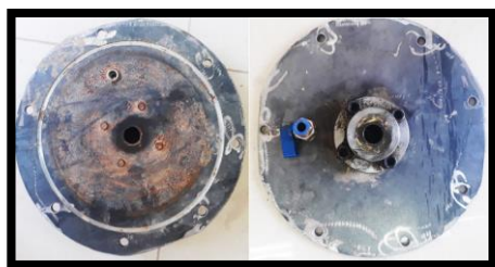
شکل ۱۳ نمای درپوش محفظه دستگاه آزمایشگاهی سنجش سایش خاک
