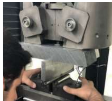
شکل (۳): تنظیم فواصل تکیه‌گاهی و موقعیت قرارگیری نمونه بر روی تکیه‌گاه
