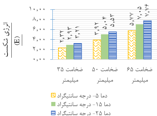
شکل (۶): نمودار تأثیر دما بر انرژی شکست نمونه‌ها در ضخامت‌های متفاوت
