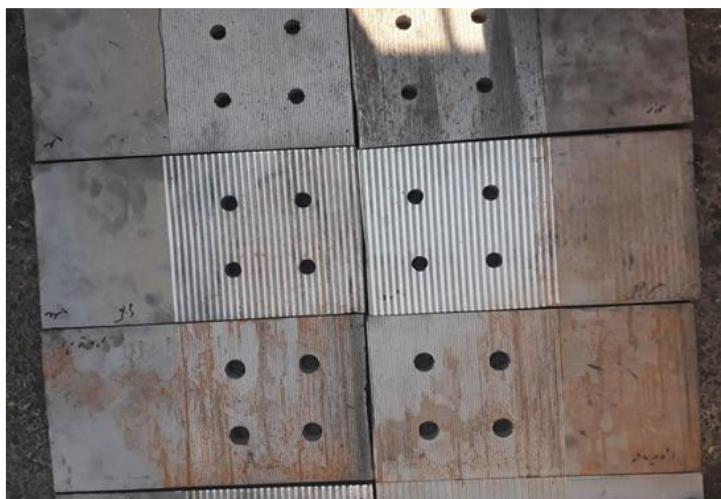
شکل ۲ آج زدن صفحات اتصال
