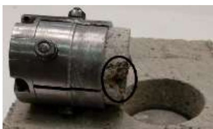
(ج) شکست در سطح مشترک + ملات تعمیری
