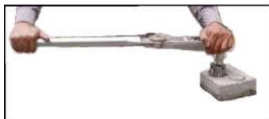
شکل «۱»: انجام آزمون "انتقال اصطکاک"
