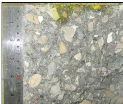
شکل ۸ نتایج آزمون تعیین عمق نفوذ نمونه‌ها تحت فشار آب در سن ۲۸ روز (عمل‌آوری بصورت غرقاب)
