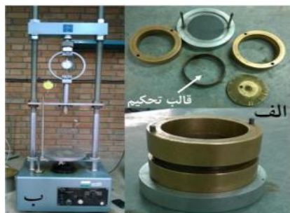
شکل ۱ الف) قالب و ب) دستگاه بارگذاری به منظور ساخت نمونه‌ها
