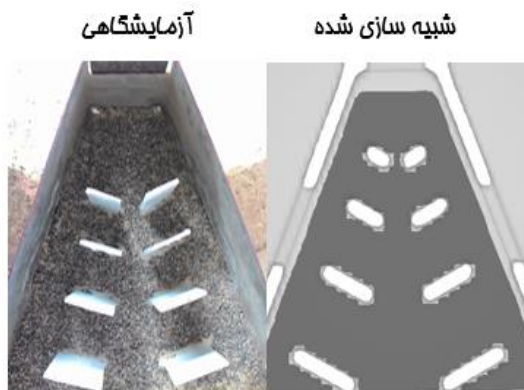
شکل ۳ الگوی رسوب‌گذاری اولیه در بالادست سرریز نوک اردکی
