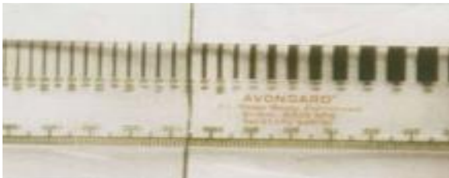
شکل ۴ خطکش مدرج اندازه‌گیری عرض ترک خوردگی
