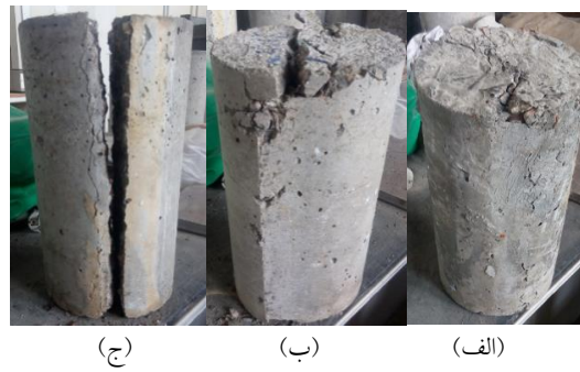
شکل ۲۳ گسیختگی کششی نمونه‌های استوانه‌ای تحت کشش غیرمستقیم
