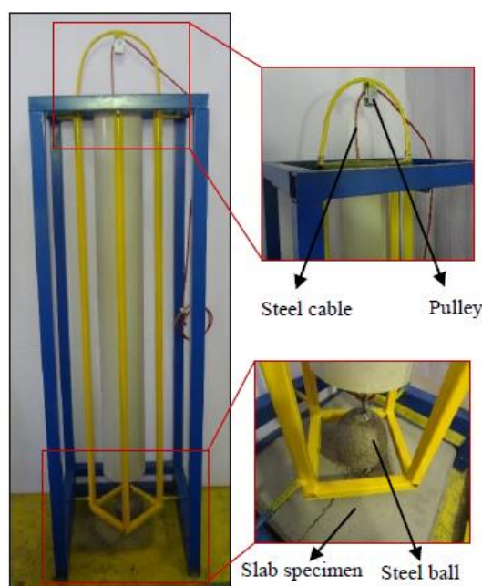
شکل ۱۱ دستگاه آزمایش ضربه وزنه افتان
