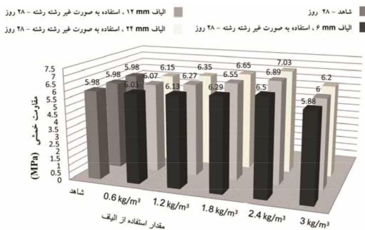
شکل ۱۳ اثر استفاده از الیاف به طول‌های ۶ mm ، ۱۲ mm و ۲۴ mm به صورت غیر رشته‌رشته بر مقاومت خمشی بتن در سن ۲۸ روز
