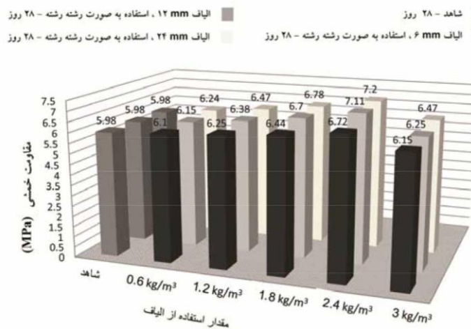
شکل ۱۴ اثر استفاده از الیاف به طول‌های 6 mm، 12 mm و 24 mm به صورت رشته‌رشته بر مقاومت خمشی بتن در سن 28 روز
