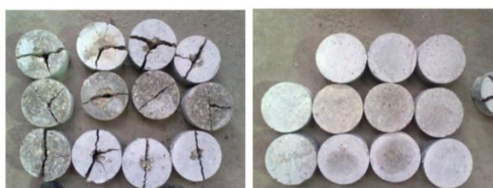
شکل ۹ نمونه‌های تست ضربه قبل و بعد از انجام آزمایش
