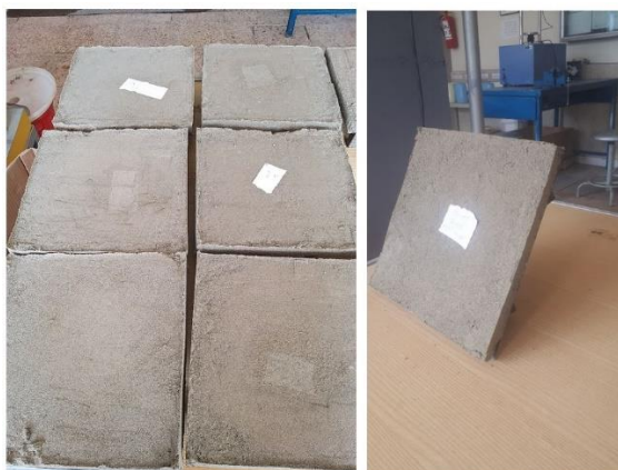
شکل ۱۰ نمونه‌های آزمایش برش مستقیم اصلاح شده بزرگ مقیاس
