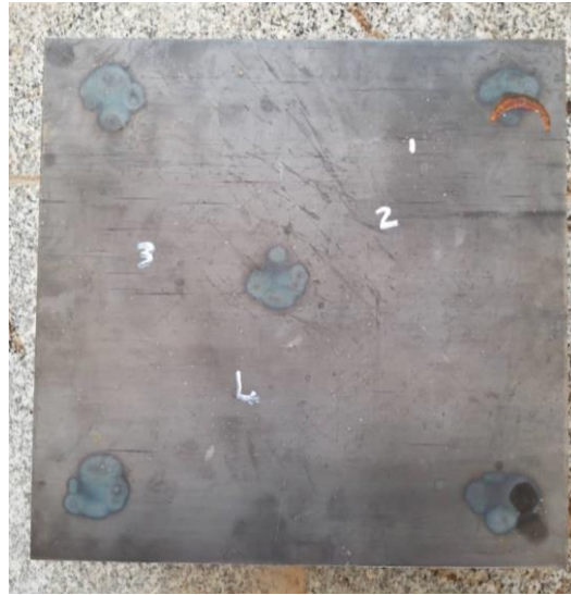
شکل ۴ نقاط انتخاب شده جهت محاسبه زبری توسط دستگاه Mitutoyo
