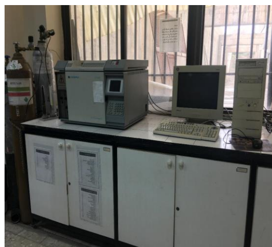
شکل ۲ دستگاه کروماتوگرافی گازی مورد استفاده در پژوهش
