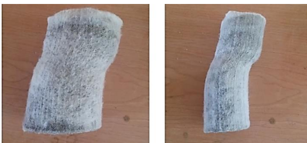
شکل ۱۲ نمونه تغییرشکل یافته ستون سنگی مسلح
