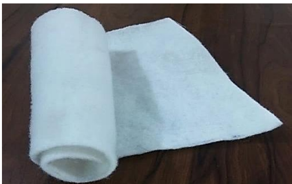
(ج) ژئوتکستایل مورد استفاده جهت تسلیح ستون سنگی
