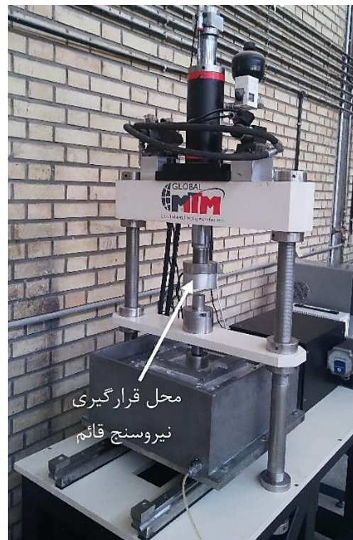
شکل ۴ تصویری از دستگاه برش مستقیم و متعلقات آن
