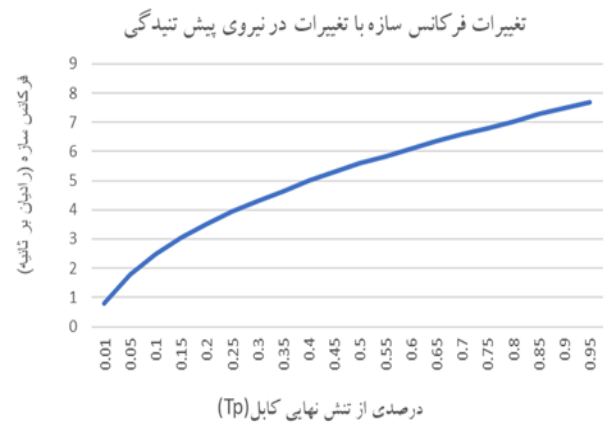
شکل ۱۳ تغییرات فرکانس طبیعی سیستم بر حسب تغییرات مقادیر نیروی پیش‌تندگی کابل به صورت درصدی از تنش نهایی کابل
