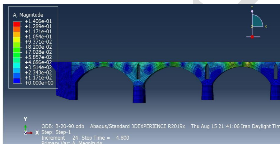
شکل (۱۸) - وضعیت شتاب وارد بر پل مصالح بنایی تحت عبور قطار با سرعت ۹۰ کیلومتر بر ساعت و بار ۲۰ تن در روسازی بالاستی
