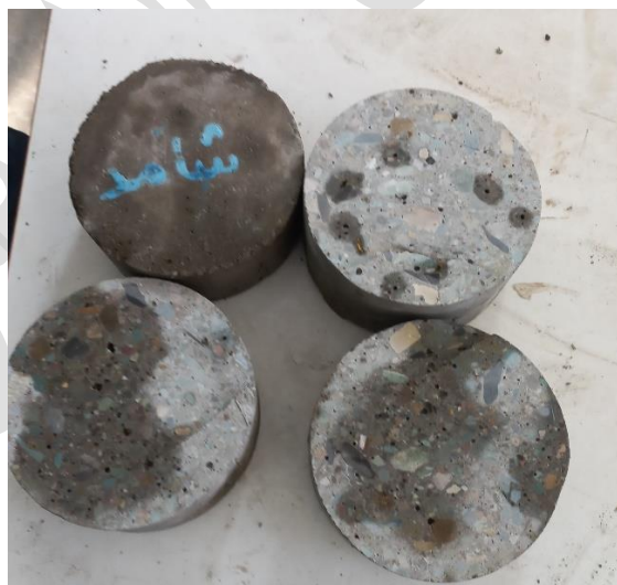
شکل ۳. نمونه‌های استوانه‌ای برش داده شده جهت انجام آزمایش سایش
