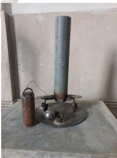
شکل ۵. دستگاه تست ضربه مطابق با استاندارد ACI544
