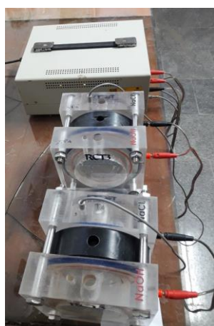
شکل ۱۱. (سمت راست): نتایج آزمایش نفوذ کلرید تسریع شده (RCPT) نمونه‌های بتنی در سن ۳ و ۲۸ روزگی (سمت چپ): انجام تست.
