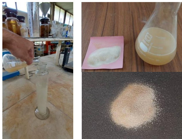
شکل ۱. مراحل آماده‌سازی و افزودن باکتری باسیلوس در حالت پودری؛ حل‌سازی دقیق آن در حجم مشخصی از آب اختلاط؛ و افزودن سوسپانسیون باکتریایی حاصل به مخلوط بتن.
