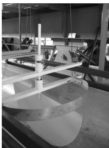
شکل ۱ دریچه دوار نیم‌دایره‌ای ساخته‌شده توسط مرعشی همکاران [18]
