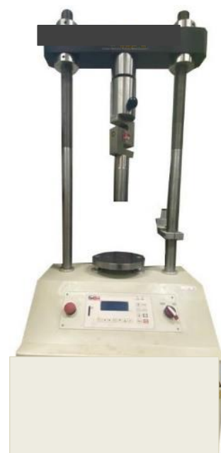
شکل ۷ دستگاه آزمایش CBR - مارشال
