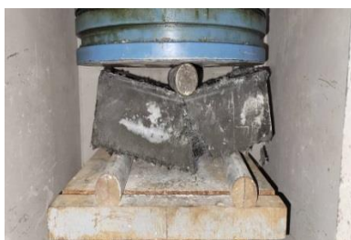
(ج) مقاومت خمشی سه نقطه‌ای
