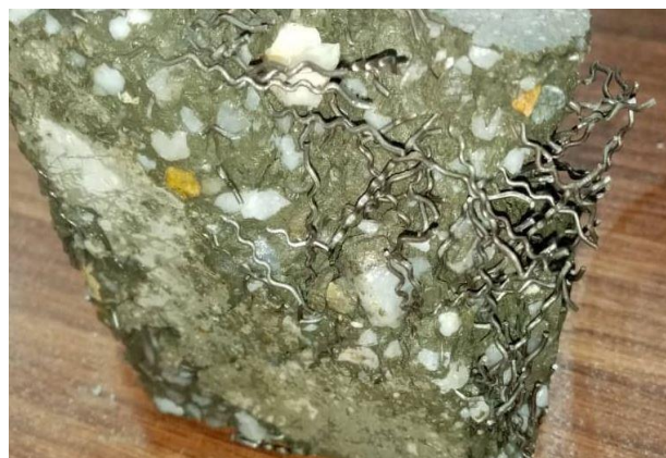
شکل ۲۲ توزیع نامتقارن الیاف فولادی در مقطع بتنی
