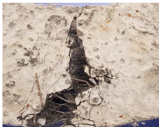
(الف) توزیع پیوسته و پل‌بندی مناسب الیاف پلی پروپیلن در دهانه ترک
