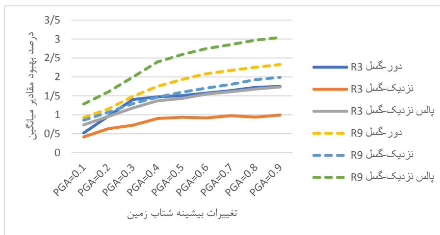
شکل ۱۲ ارزیابی اثر کنترل فازی در مقایسه با کنترل بهینه خطی بر بیشینه و جذر مجموع مربعات شتاب تحت تأثیر انواع زلزله در پرپود ۱/۳ ثانیه
