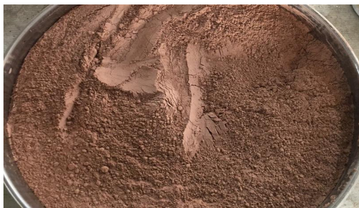
شکل ۳. پودر سرامیک ضایعاتی مصرفی
