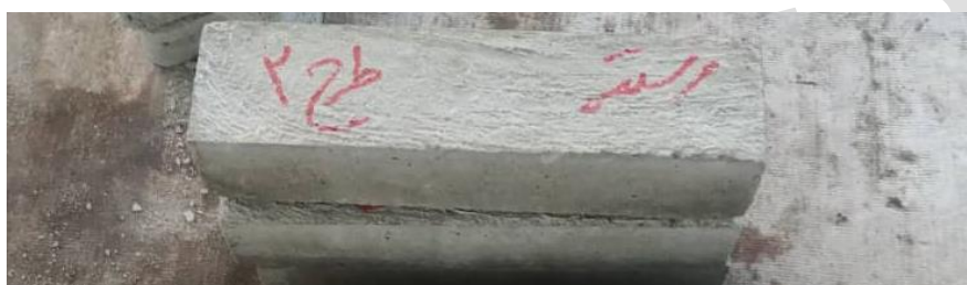
شکل ۹. نمونه‌های ساخت شده خمشی ملات
