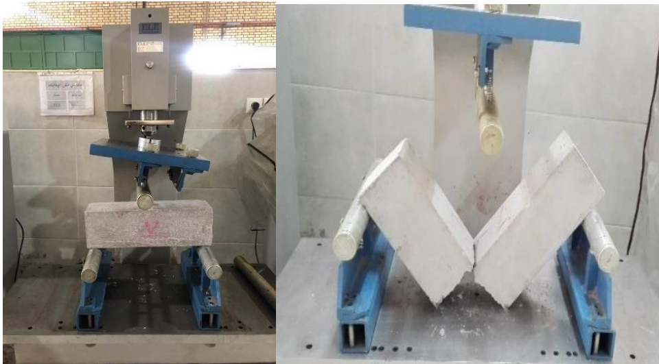
شکل ۷. آزمایش مقاومت خمشی نمونه‌های بتن سبز حاوی الیاف پلی پروپیلن و خاکستر باگاس با استفاده از جک هیدرولیکی
