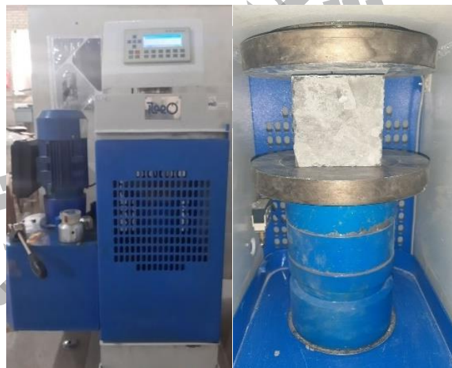
شکل ۶. آزمایش مقاومت فشاری نمونه‌های بتن سبز حاوی الیاف پلی‌پروپیلن و خاکستر باگاس با استفاده از جک هیدرولیکی
