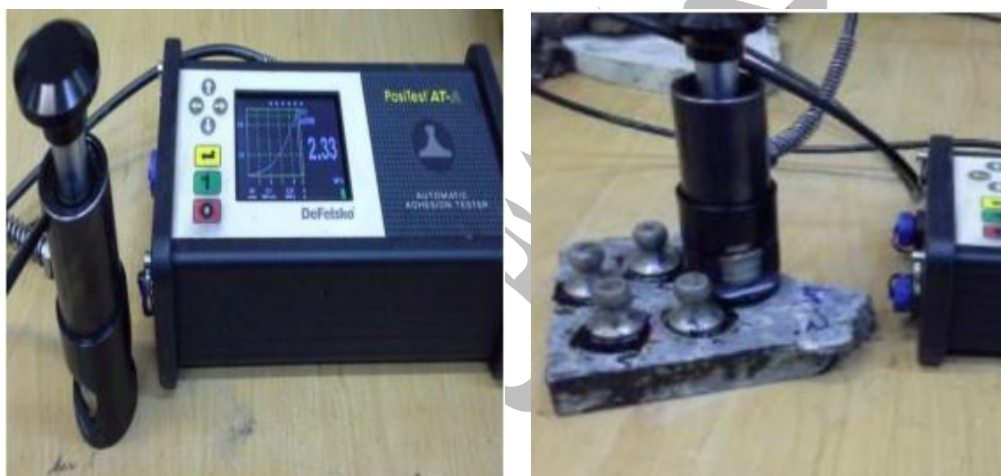
شکل ۲- قرارگیری نمونه ها در آزمایش PULL OFF
